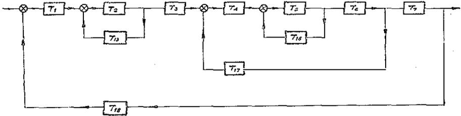
$$M^{-1} \cdot R = \left\{ \left[ \left[ \left[ (T_5^{-1} + T_{16}) \cdot T_4^{-1} \right] \cdot T_6^{-1} + T_{17} \right] \cdot T_3^{-1} \right] \cdot T_7^{-1} \right] \cdot T_1^{-1} \right\} \cdot (T_2^{-1} + T_{13}) + T_{18}$$
